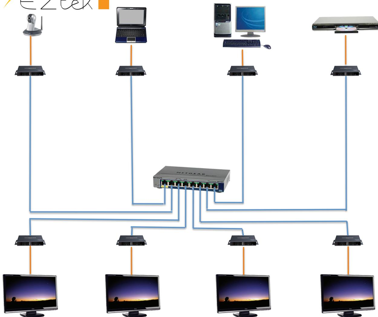
La distribution de signal utilisant le protocole de transmission Internet (AV over IP) consiste à transformer le signal video + audio en «paquets» de données au format de transmission Internet, afin de pouvoir utiliser les infrastructures des réseaux informatiques standards. Le flux video est «encodé» par le récepteur et remis au format HDMI pour aller dans le moniteur ou le projecteur.
